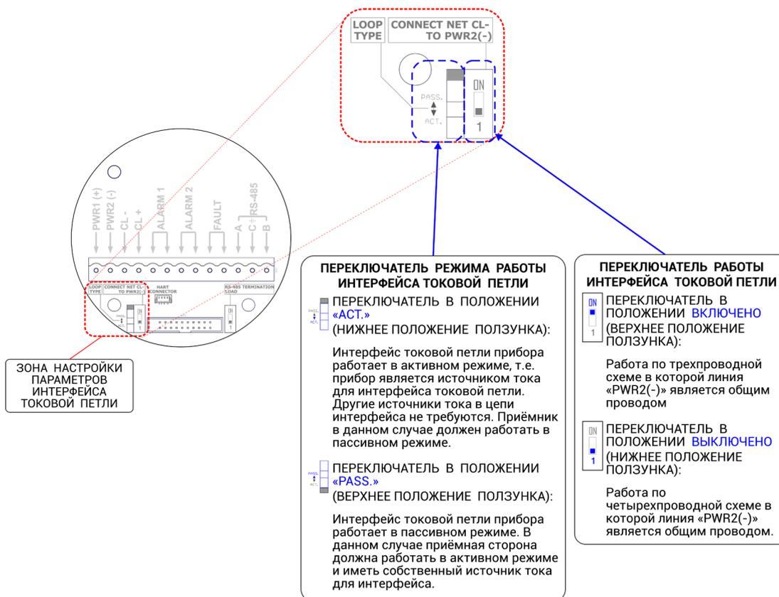
Рисунок 7 – Настройка параметров интерфейса токовой петли для ИГМ-10
