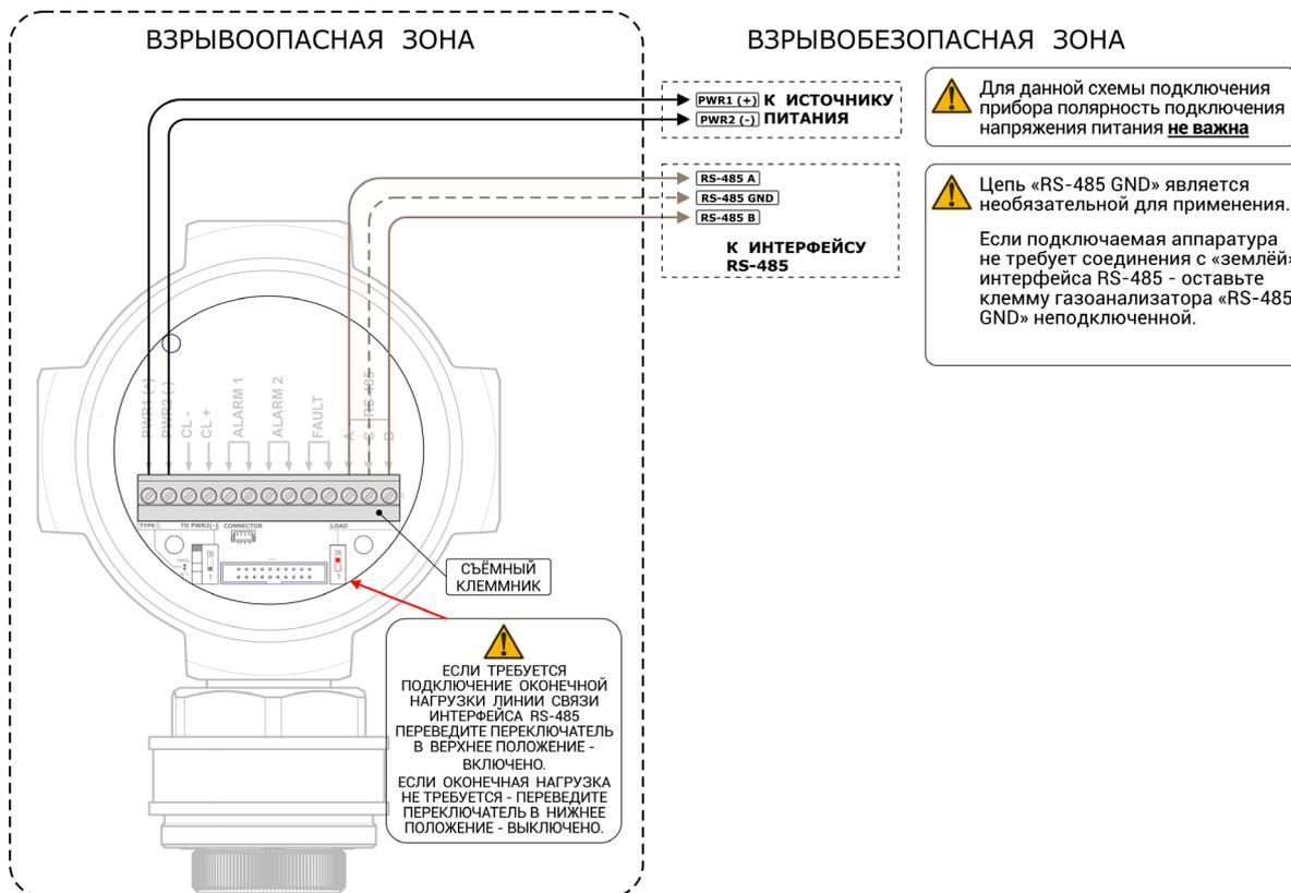
Рисунок Ж.6 – Подключение по интерфейсу RS-485
