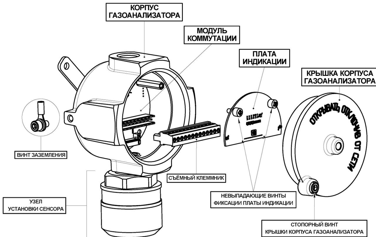
Рисунок 4 – Функциональный состав ИГМ-10
