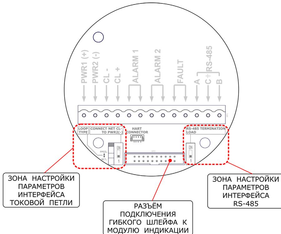
Рисунок 6 – Расположение и функциональное назначение переключателей настройки параметров работы интерфейсов ИГМ-10
