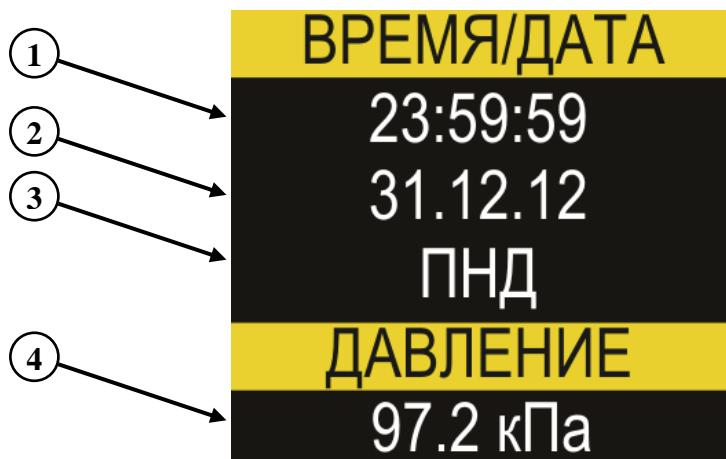
Рисунок 7. Дисплей в режиме "Дата и время"
