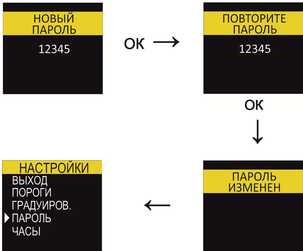
Рисунок 10. Дисплей в режиме "ПАРОЛЬ"
