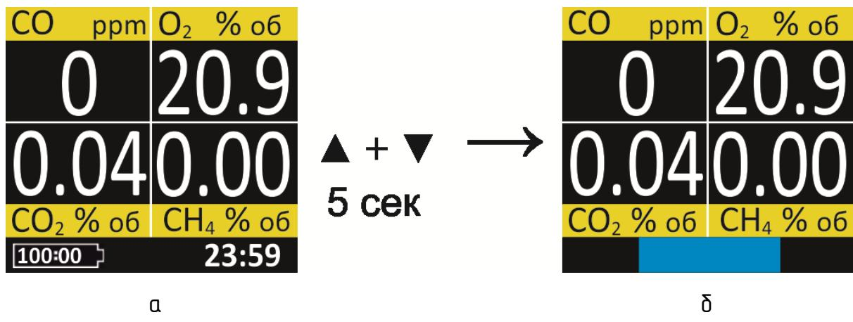
Рисунок 4. Снятие блокировки дисплея
